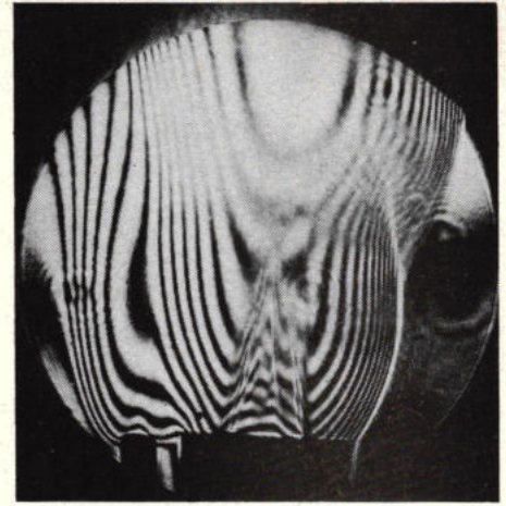
Afb. 11. Holografisch interferogram van een gasvlam, gemaakt met een Mach-Zehner interferometer.
